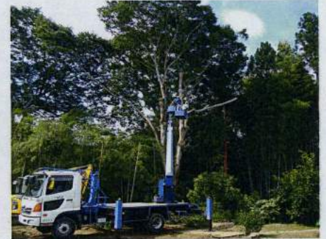
高所作業車による伐採
